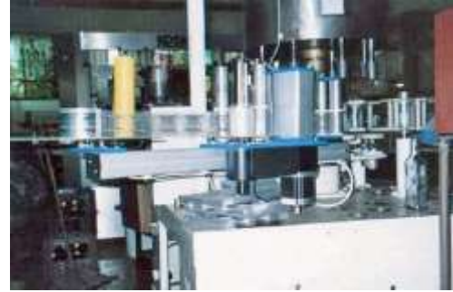
Рисунок 1.6 - Пристрій розмотування та подачі плівкового матеріалу
