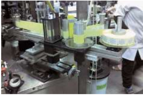
Рисунок 1.6 - Пристрій розмотування та подачі плівкового матеріалу
