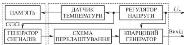
Рис. 4. Функціональна схема цифрового ТККГ: ССКЗ – схема синтезу компенсуючої залежності
