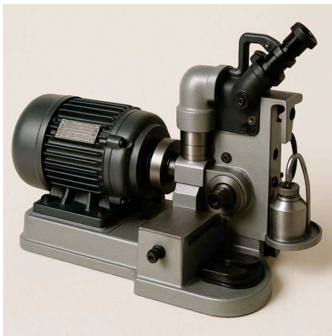
Рисунок 2.6 – Зовнішній вигляд пристрою для дослідження покриттів лакових шкір на багаторазовий згин
