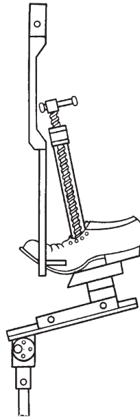
Рисунок 1.7 - Пристрій до динамометра для визначення жорсткості конструкції взуття
