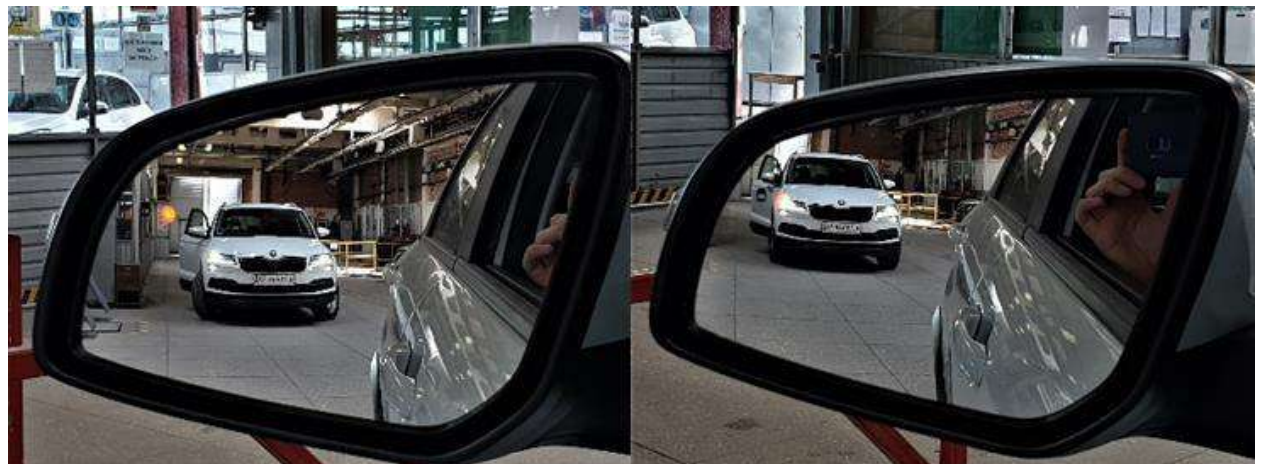
Рисунок 10 – Перекриття індикатора сліпих зон світлом фар
