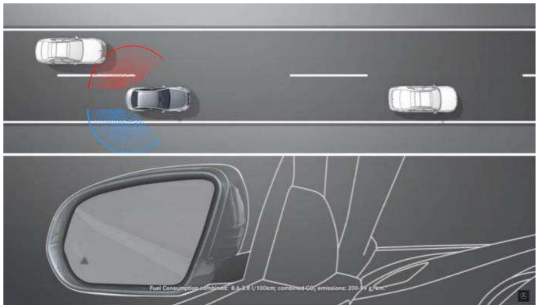
Рисунок 18 – Датчики сліпих зон Active Blind Spot Assist від Mercedes Benz
