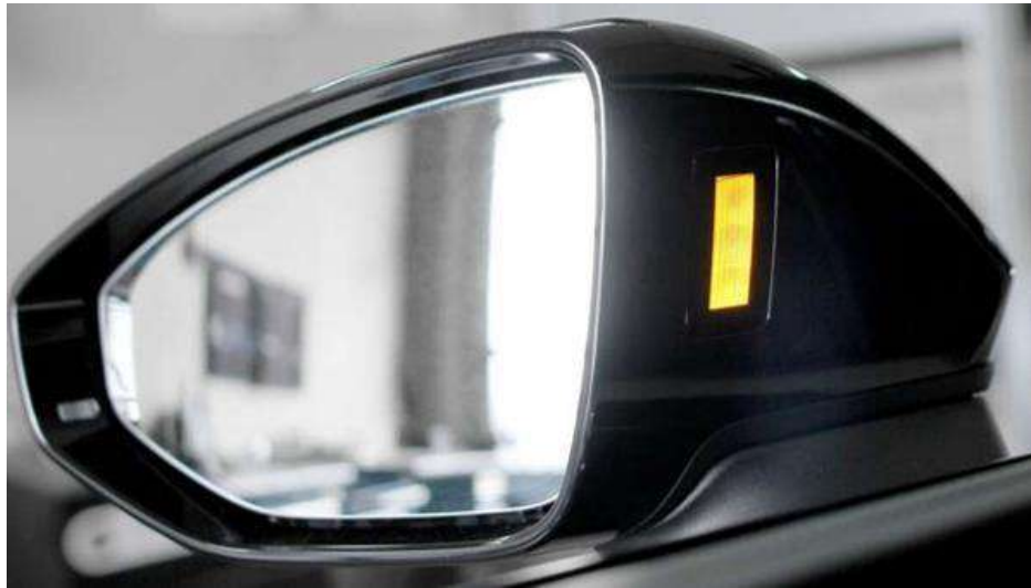
Рисунок 14 – Приклад застосування індикатора винесеного на внутрішню стінку дзеркала у автомобілях AUDI
