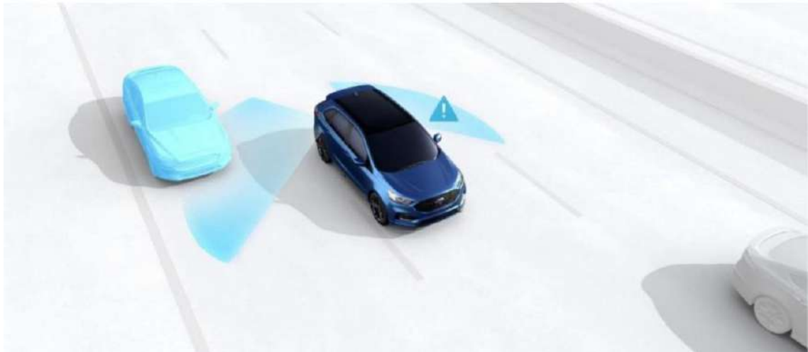
Рисунок 19 – Радіус дії датчиків система BLIS від FORD
