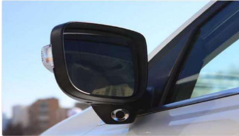
Рисунок 17 – Дзеркало заднього виду із сенсором сліпої зони у вигляді камери
