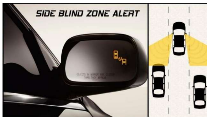
Рисунок 21 – Радіус дії датчиків Side Blind zone alert
