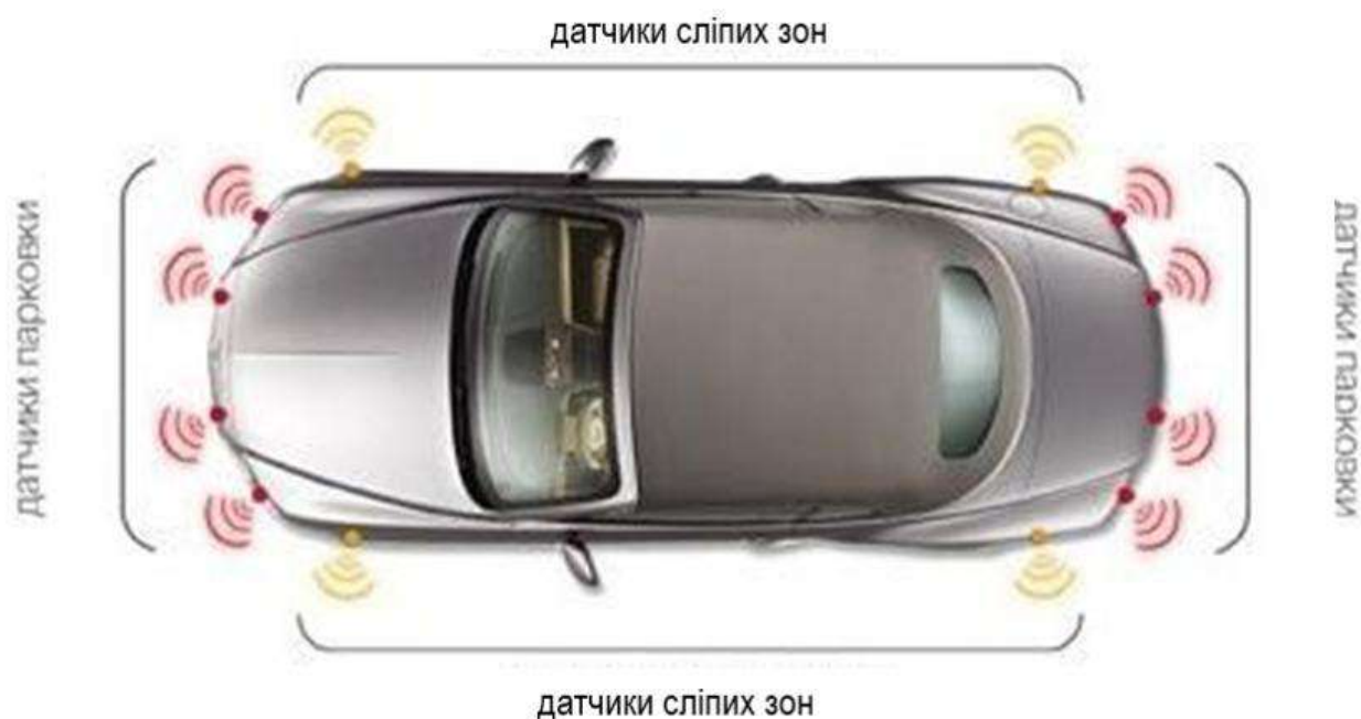
Рисунок 16 – Розташування сенсорів у вигляді радарів на автомобілі
