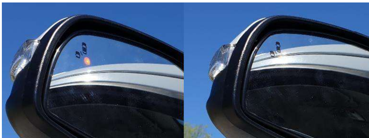
Рисунок 8 – Перекриття сонячними відблисками індикатора сліпих зон
