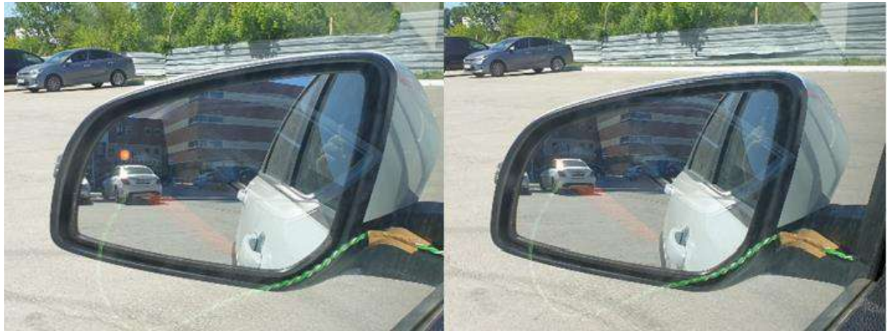
Рисунок 9 – Вигляд відблисків із салону автомобіля
