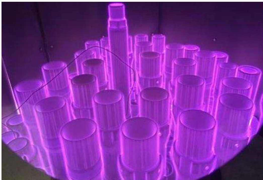
Рисунок 2.1 – Вигляд робочої камери під час процесу іонного азотування: деталі рівномірно оточені плазмою, що забезпечує активне насичення поверхні азотом
