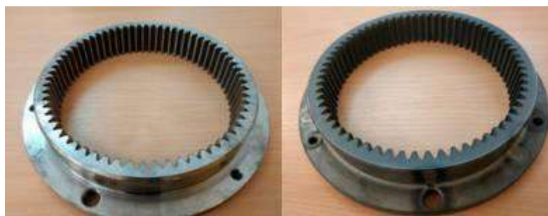
Рисунок 1.1. Внутрішньозубчаста шестерня планетарного (епіциклічного) редуктора: а – до обробки зі слідами використання; б – після азотування
