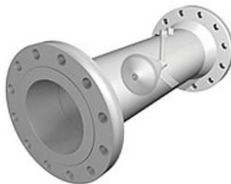
Рисунок 1.4 - 8-дюймовий (203 мм) V-подібний витратомір показаний з ANSI 300# (21 бар; 2,1 МПа) фланцями горловини з привареними поверхнями
