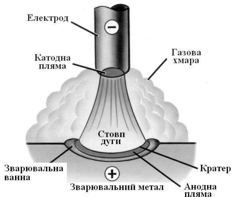
Рисунок 1.5 – Схема горіння зварювальної дуги
