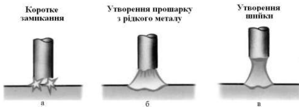
Рисунок 1.4 – Розпалювання зварювальної дуги
