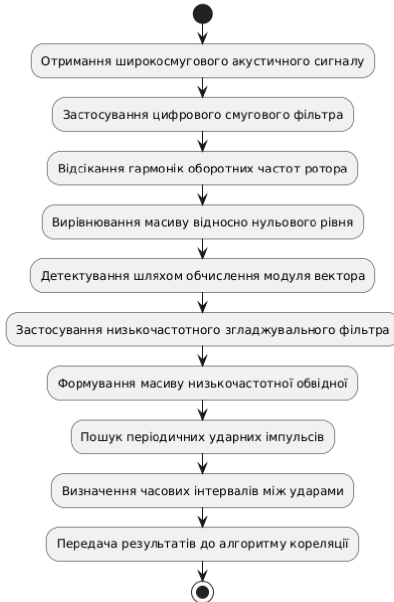
Рисунок 3.8 – Блок-схема програмного модуля виділення обвідної акустичної емісії
