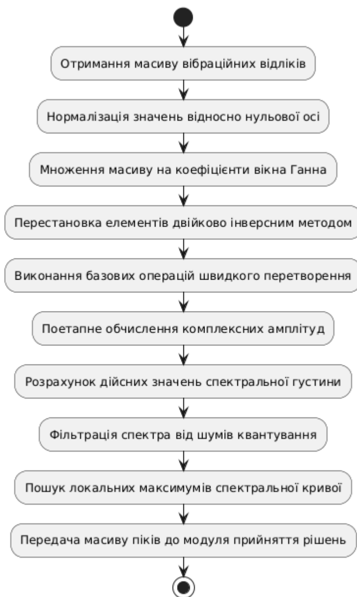
Рисунок 3.7 – Блок-схема програмного модуля розрахунку спектра вібрації
