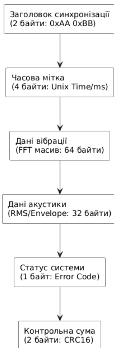
Рисунок 2.11 – Структурна модель діагностичного пакета передачі даних
