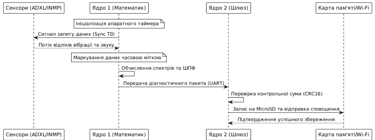
Рисунок 2.10 – Діаграма послідовності сигналів синхронізації мультисенсорних потоків
