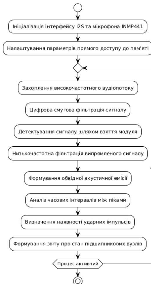
Рисунок 2.9 – Блок-схема алгоритму виділення обвідної акустичної емісії
