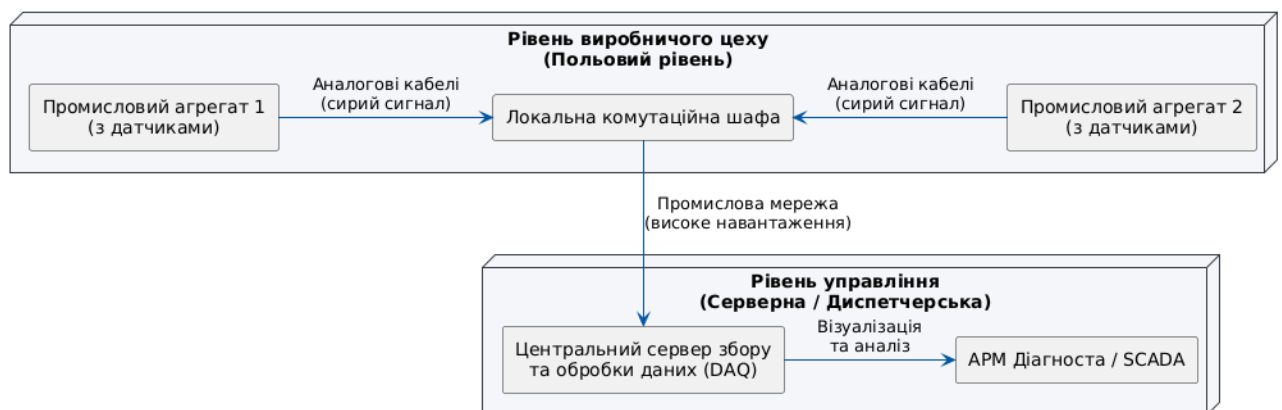
Рисунок 1.3 – Архітектура традиційної централізованої системи вібромоніторингу
