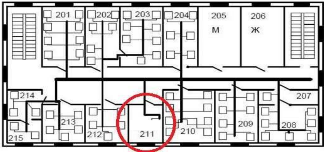
Рисунок 3.4 – Апаратний вузол в будівлі
