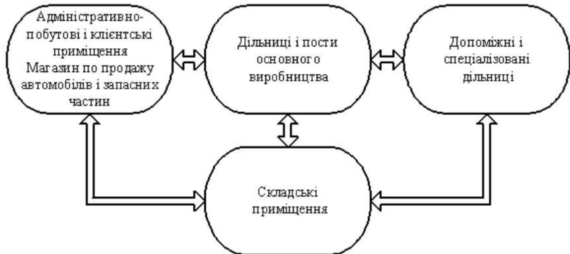
Рисунок 2.1 – Функціональне зонування СТО автомобілів [9]
