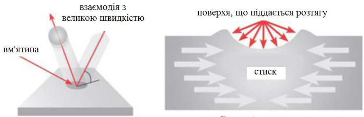
Рисунок 1.6 – Механізм дробоструменевої обробки.
