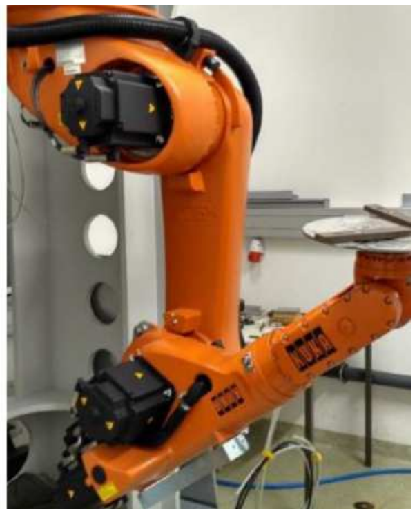
Рисунок 2.8 – Робот-маніпулятор КУКА 30 НА [19]: 1 – зап'ястя; 2 – рука; 3 – ланка руки; 4 - колона, що обертається; 5 – опора
