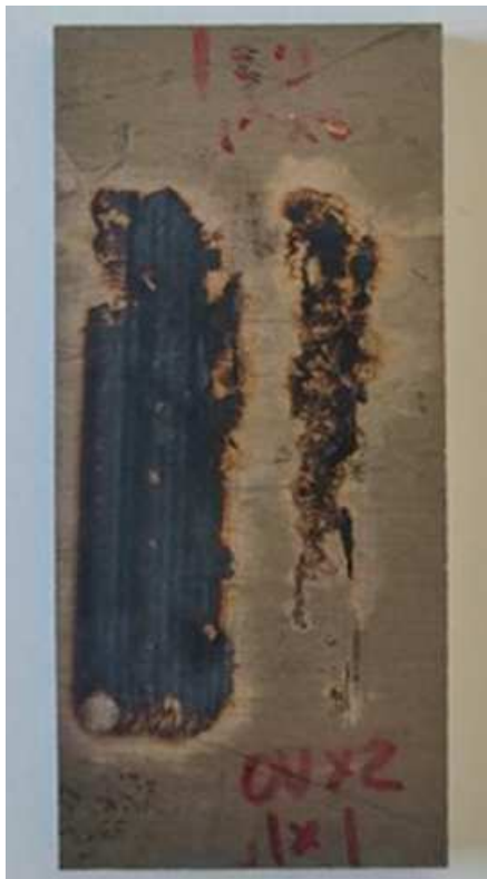
Рисунок 3.7 – Результат лазерної обробки зразка при 5 Дж.
