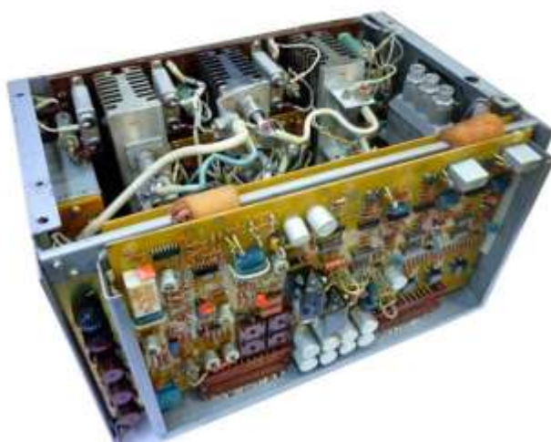
Рисунок 1.1 – Загальний вигляд електроприводу БТУ3601
