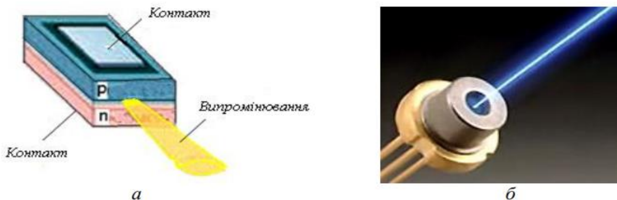
Рисунок 1.5 – Схема формування випромінювання діодного лазера (а) та його загальний вигляд (б)
