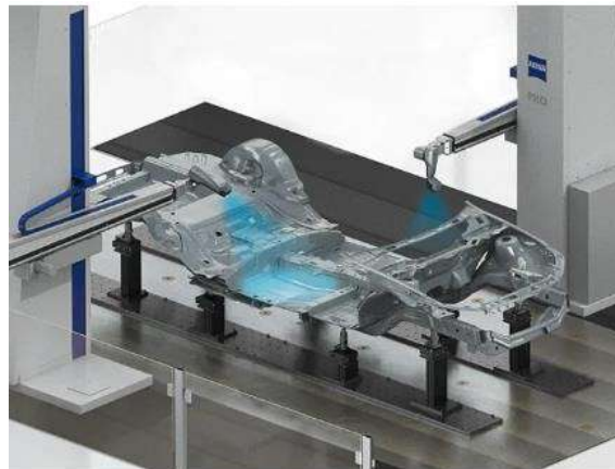
Рисунок 1.20 Контроль геометрії велико-вузлового елемента кузова
