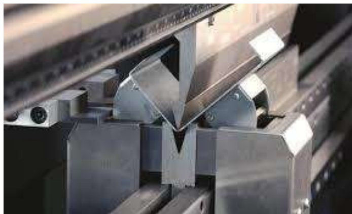
Рисунок 1.14 – Технологія виготовлення лонжеронів згинанням.
