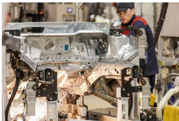
Рисунок 1.17 – Зварювання елементів кузова у кондукторі
