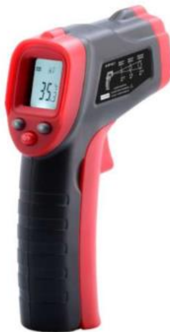
Рисунок 1.5 – Безконтактний інфрачервоний пірометр WT319B
