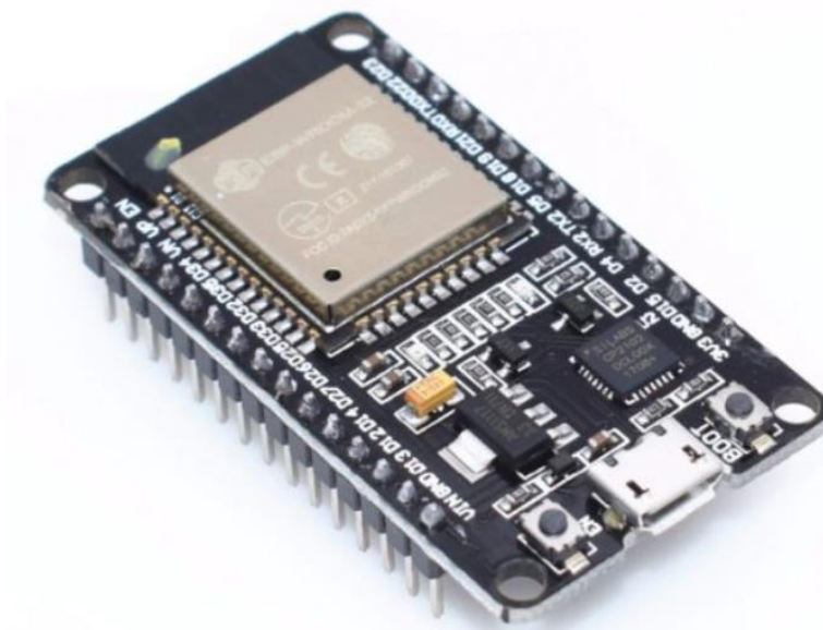
Рисунок 2.8 – Мікроконтролерна плата ESP32
