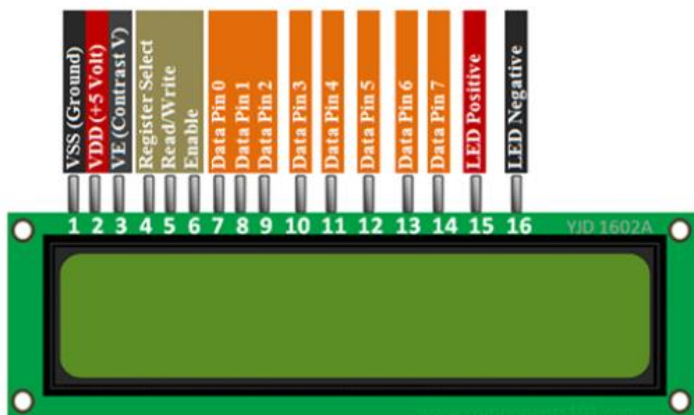
Рисунок 2.7 – Контакти LCD дисплею
