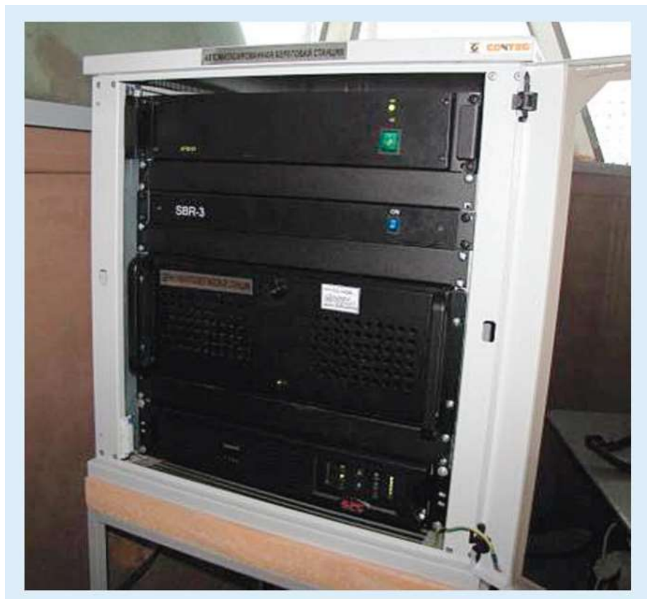
Рисунок 2.2 – Апаратні складові АІС (модулятор/демодулятор)
