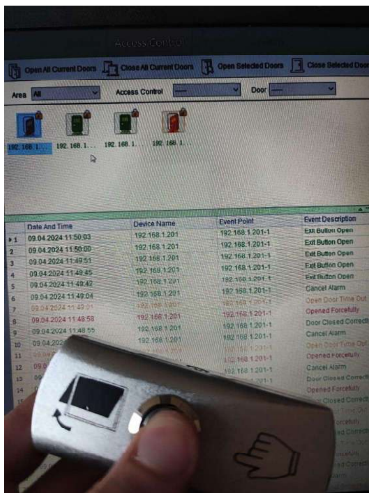
Рисунок 3.6 – Реакція системи на натиск кнопки відкриття дверей
