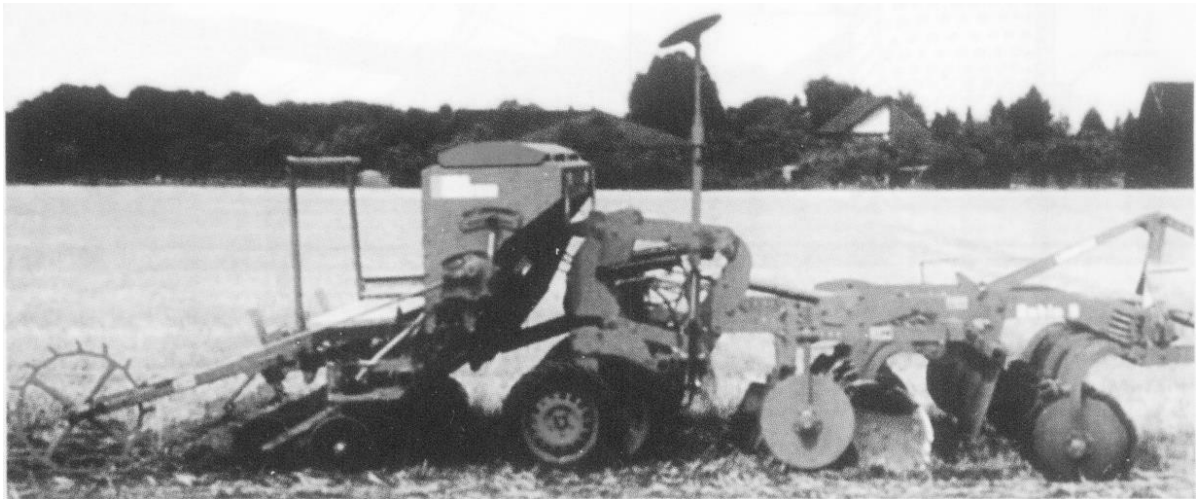
Рис.1.11 Комбінація сівалки Солітер 9КА і напівнавісного культиватора Рубін
