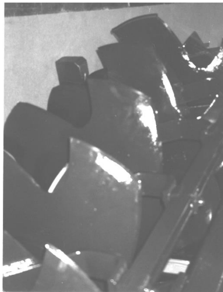
Рис.1.8 Існуючі форми вирізів дисків
