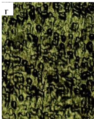
Рисунок 5.8 – Зображення сплавлених шарів 25% (за масою) WC та 75% (за масою) Co (а) шар з перекриттям 0%, (б) підкладка, (в) шар з перекриттям 30%, (г) шар із перекриттям 50%
