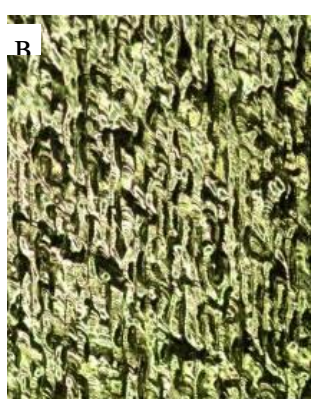
Рисунок 5.8 – Зображення сплавлених шарів 25% (за масою) WC та 75% (за масою) Co (а) шар з перекриттям 0%, (б) підкладка, (в) шар з перекриттям 30%, (г) шар із перекриттям 50%
