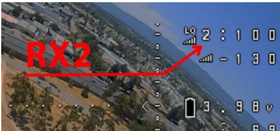
Рисунок 3.19 - Приклад OSD з активним другим приймачем (RX2)
