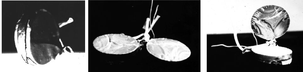
Рис. 2. Рельєф поверхні руйнування конденсатора
