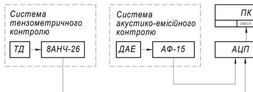
Блок-схема вимірювального комплексу для експериментального дослідження виробів електронної техніки
