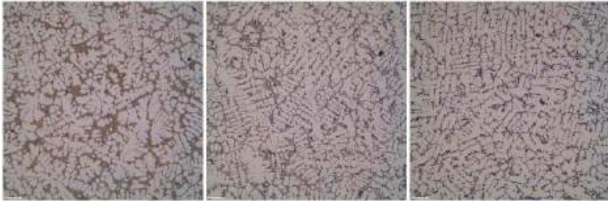
Рисунок 3.14 – Порівняння структур не термооброблених зразків: а - структура зразка 1 отриманого за стандартною технологією приготування розплаву; б - структура зразка 9 отриманого за технологією з додаванням ШЗС і витримкою в печі 15 хвилин; в) - структура зразка 10 отриманого за технологією з додаванням ШОС і витримкою в печі 180 хвилин.
