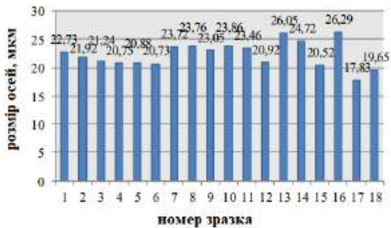
Рисунок 3.18 – Розміри вторинних осей дендритів зразків.
