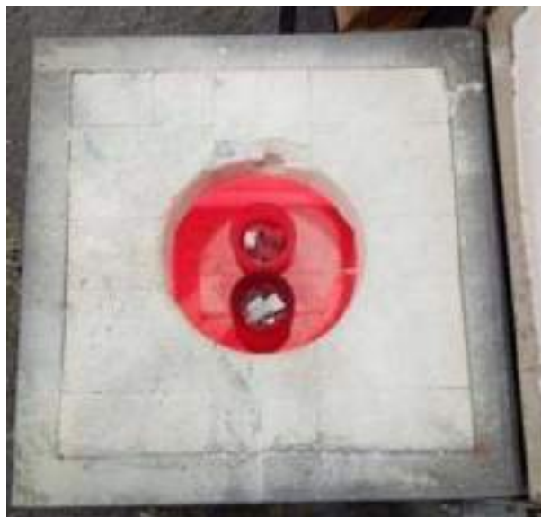
Рисунок 2.8 – Послідовне завантаження шматкового алюмінію в тиглі.
