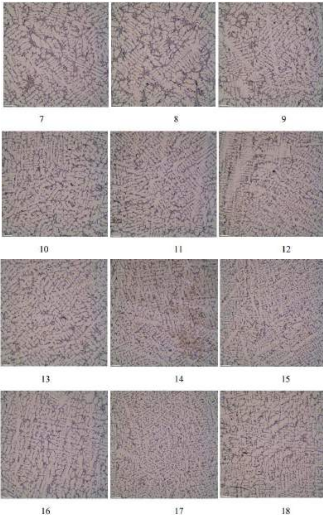
Рисунок 3.7 – Мікроструктура зразків AlSi7Mg0,3 сплаву з застосуванням технології з додаванням модифікатора ШОС.
