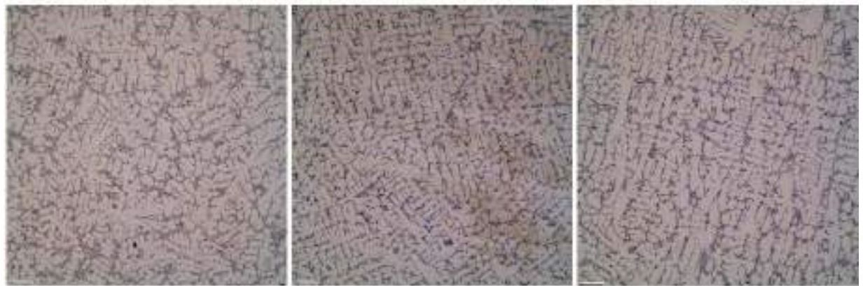
Рисунок 3.14 – Порівняння структур не термооброблених зразків: а - структура зразка 1 отриманого за стандартною технологією приготування розплаву; б - структура зразка 9 отриманого за технологією з додаванням ШЗС і витримкою в печі 15 хвилин; в) - структура зразка 10 отриманого за технологією з додаванням ШОС і витримкою в печі 180 хвилин.
