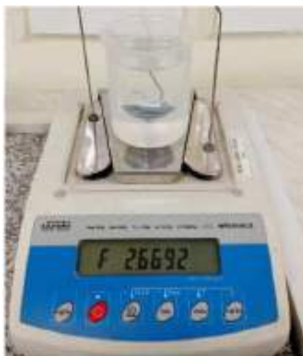
Рисунок 2.20 – Зважування зразків гідростатичне.
