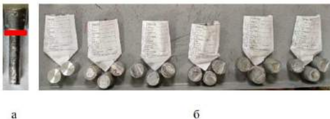
Рисунок 2.12 – Підготовка зразків до механічних випробувань: а – відокремлення верхньої частини зразка від нижньої б – підготовка до механічних випробувань.
