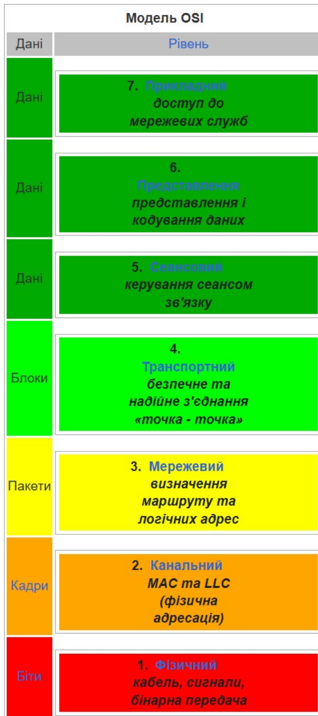
Рисунок 1.1 – Рівні моделі OSI
