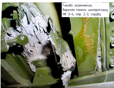
Рис. 1. Ушкодження розшарувальною корозією верхніх панелей СЧК після 15 років експлуатації літака Ан-24 в умовах вологого тропічного клімату
