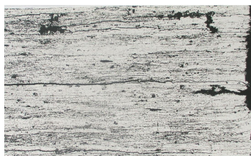
Рис. 1. Ушкодження розшарувальною корозією верхніх панелей СЧК після 15 років експлуатації літака Ан-24 в умовах вологого тропічного клімату
