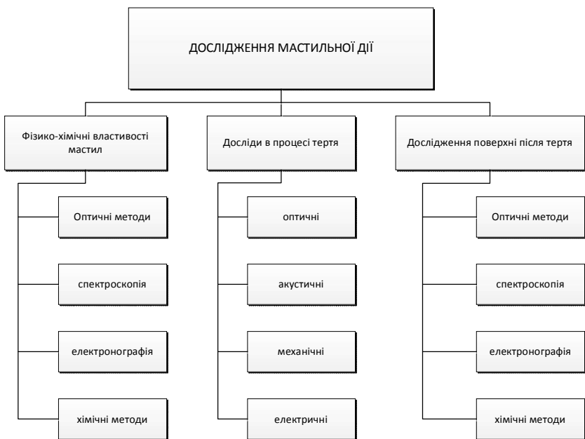
Рис. 1.2. Зведена блок-схема основних методів дослідження мастильної дії
