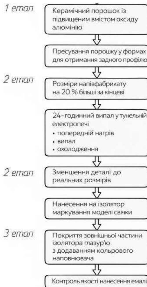
Рисунок 2.1 – Схема керамічного виробництва
