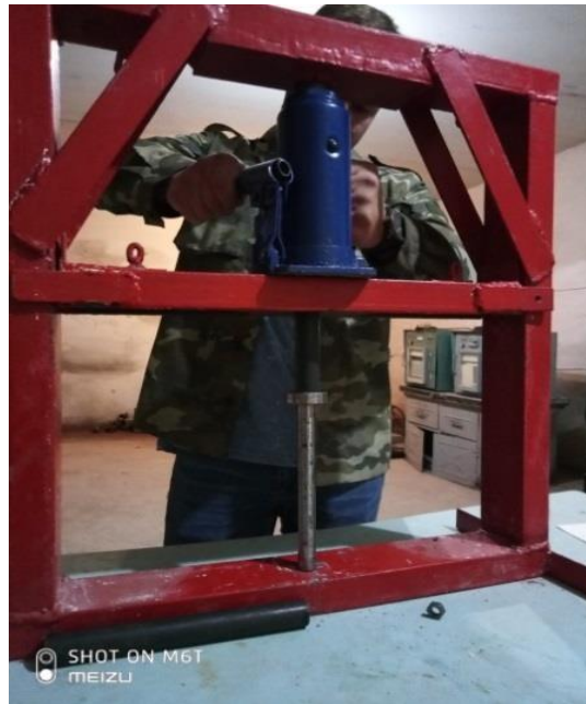
Рисунок 2.4 – Прес на 10 тс із оправкою для випробувань на міцність зчеплення
