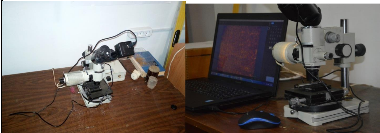
Рисунок 2.3 – Мікроскоп ММУ-3 з цифровою приставкою: а – вид мікроскопа з цифровою приставкою; б - підключена приставка до персонального комп'ютера.
