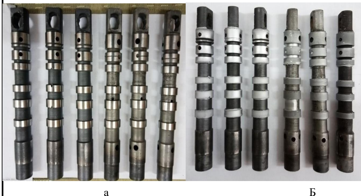
Рисунок 3.1 – Зовнішній вигляд золотників: а – підготовлених для хромування, б – покритих хромом
