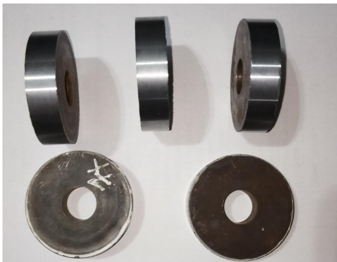
Рисунок 2.8 – Фото зразків для випробувань на зношування: а – ролики покриті хромом, б – колодка (контртіло)
