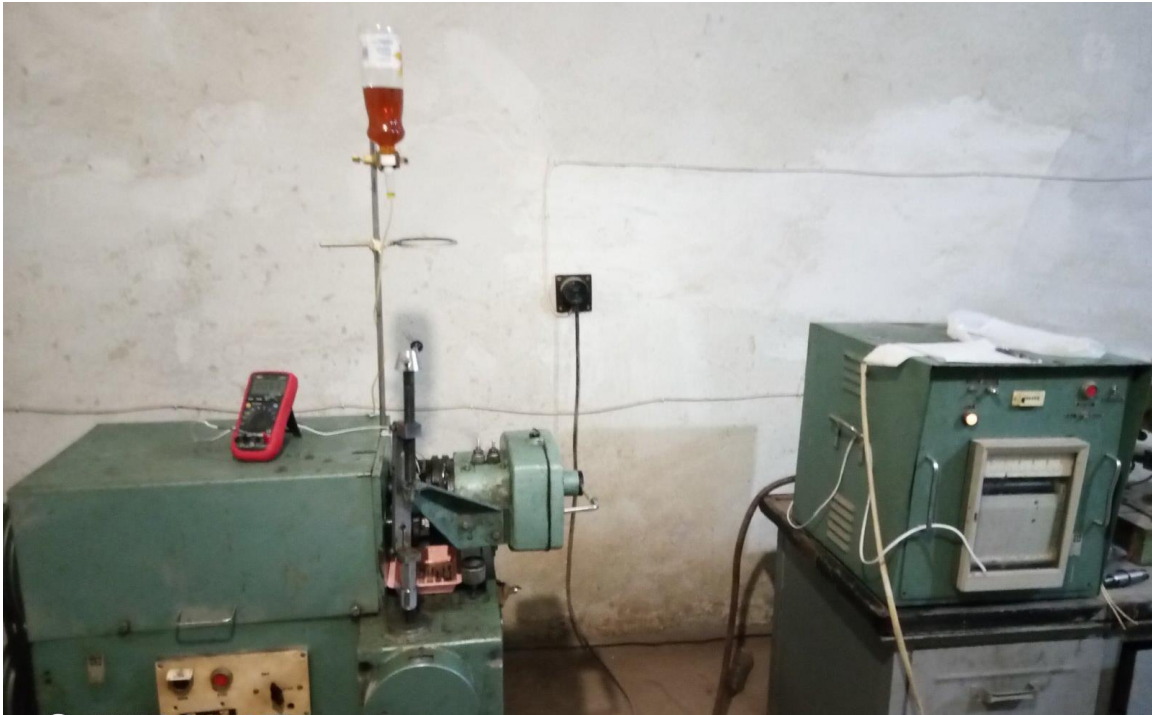
Рисунок 2.6 – Машина тертя СМЦ-2М для випробування хромових покриттів на знос
