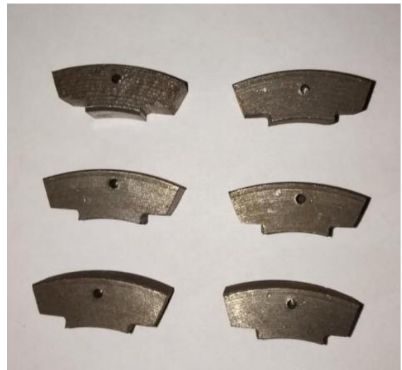
Рисунок 2.8 – Фото зразків для випробувань на зношування: а – ролики покриті хромом, б – колодка (контртіло)
