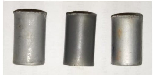
Рисунок 2.1 – Зразок-втулка: а – креслення, б – покриті хромом
