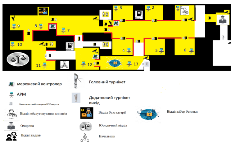
Рисунок 3.12 схема приміщення з комп'ютерами та розміщення відеокамер вхідний контроль
