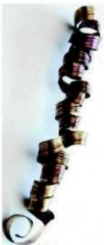
Рисунок 6. – Стружка утворена під час експерименту
