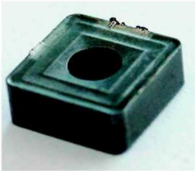
Рисунок 4. – Наріст утворений під час експерименту
