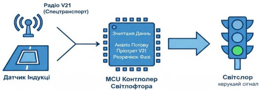
Рисунок 3.1 - Блок-схема алгоритму роботи MCU
