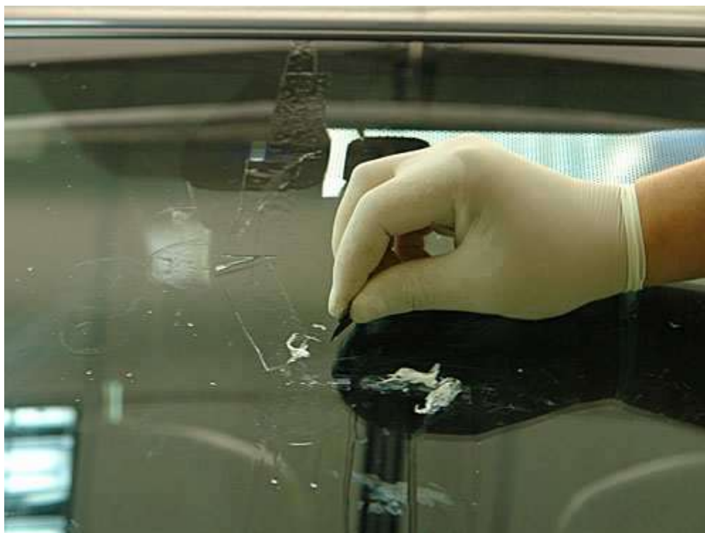
Рисунок 2.14 – Зарівнювання пошкодженої ділянки
