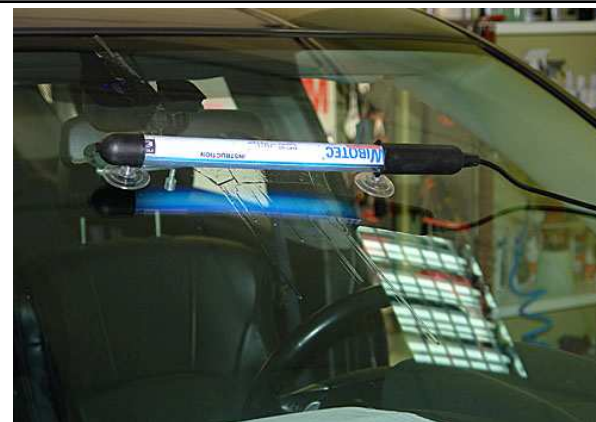
Затвердіння під впливом ультрафіолетової лампи
