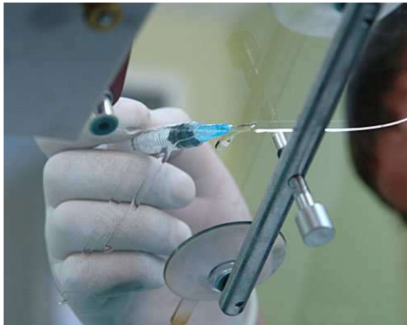
Рисунок 2.11 – Пошкодження акуратно «продавлюють» за допомогою розширювача
