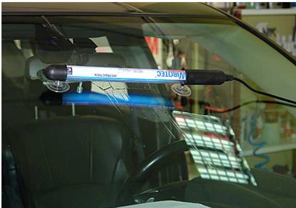
Рисунок 2.13 – Затвердіння під впливом ультрафіолетової лампи
