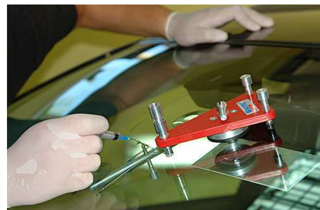
Заливається полімер за допомогою шприца
