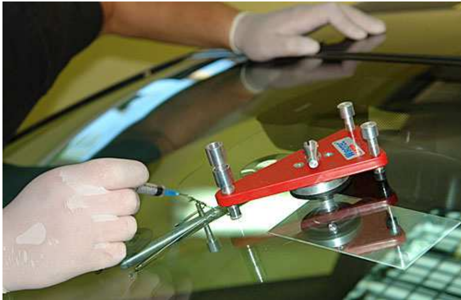
Рисунок 2.10 – Заливається полімер за допомогою шприца
