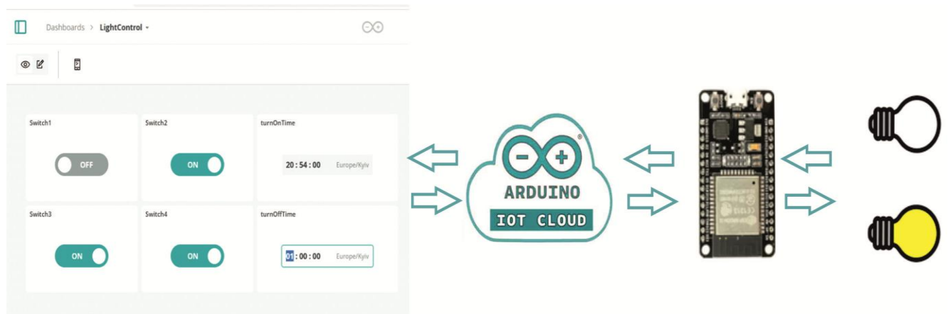
Рисунок 2.7 – Концепт керування освітленням у системі Розумного будинку на основі взаємодії ESP32 та Arduino Cloud
