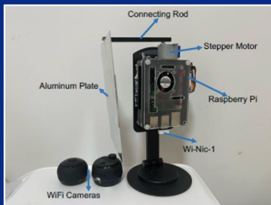
Приклад прототипу системи з дифракційним елементом
