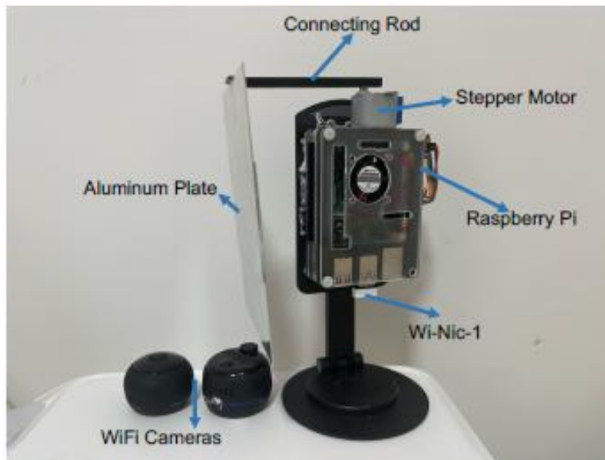
Рисунок 1.2 - Приклад прототипу системи з дифракційним елементом
