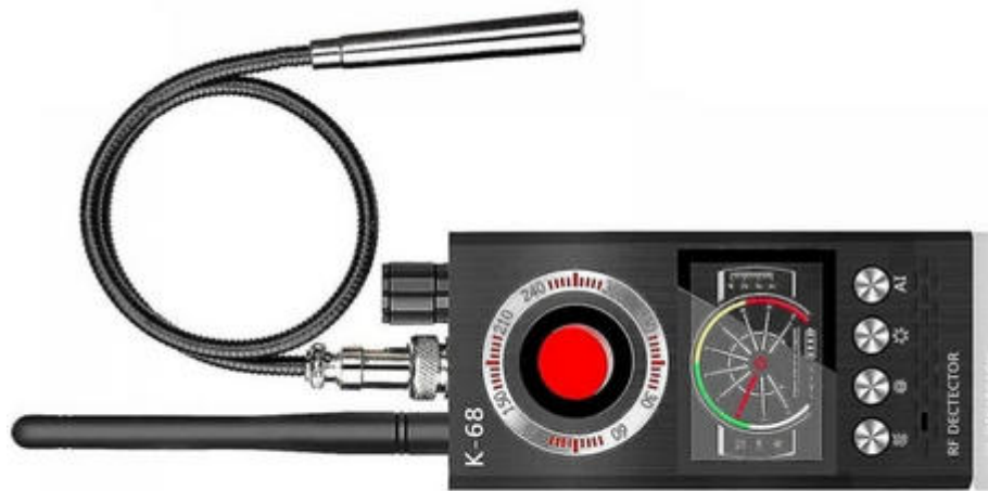
Рисунок 7 – Зовнішній вигляд детектора безпроводних сигналів I-Tech K68
