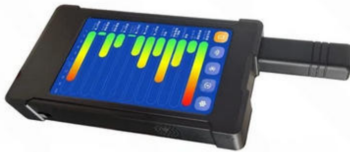
Рисунок 6 – Зовнішній вигляд детектора безпроводних сигналів XXT-DT-Pro
