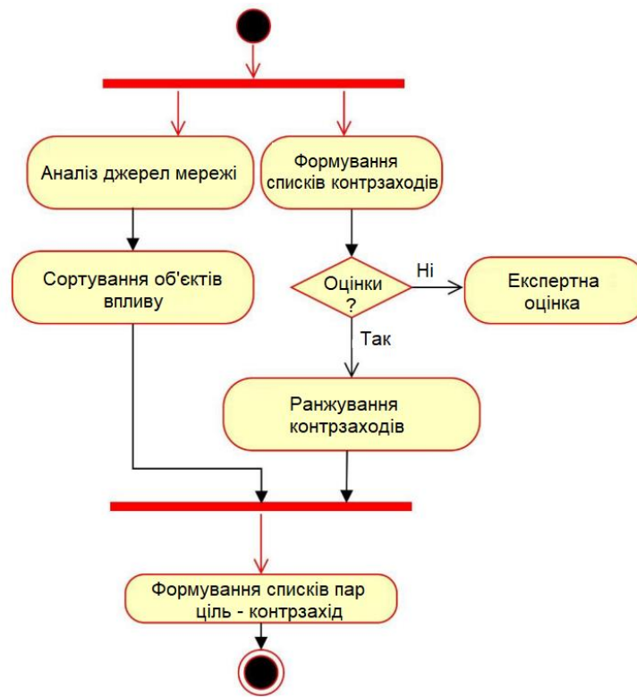
Рисунок 3.5 – Діаграма алгоритмів аналізу джерел повідомлень та ранжування контрзаходів
