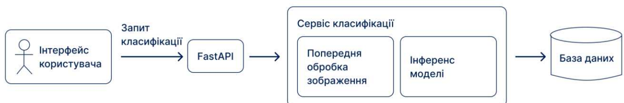
Рисунок 2.7 – UML компонентна діаграма архітектури системи
