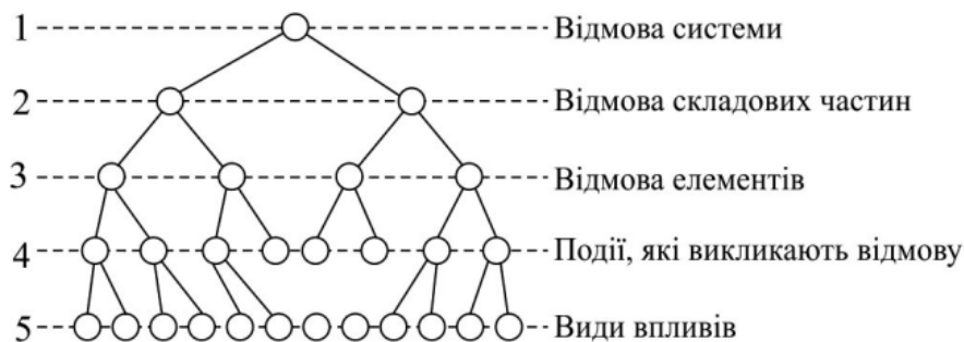
Рисунок 1.6 – Схема проведення аналізу дерева відмов (FTA)
