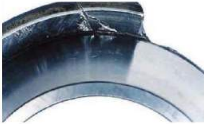
Рисунок 1.10 – Внутрішнє кільце сферичного роликopідшипника з розломом на великому буртику
