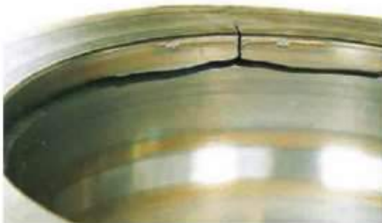
Зовнішнє кільце дворядного циліндричного роликопідшипника з тріщинами, спрямованими назовні в осьовому та периферійному напрямках від осередку розвитку втомного викришування на поверхні доріжки кочення.
