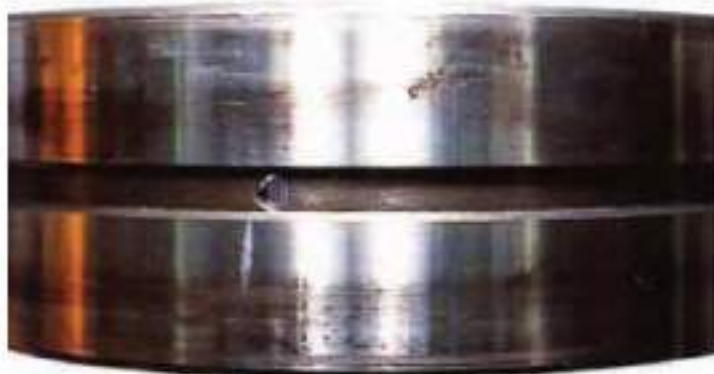
Рисунок 1.12 – Повзучість по всій поверхні зовнішнього кільця підшипника кочення
