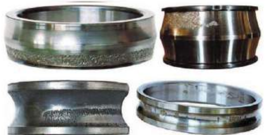
Втомне викришування доріжок підшипника
