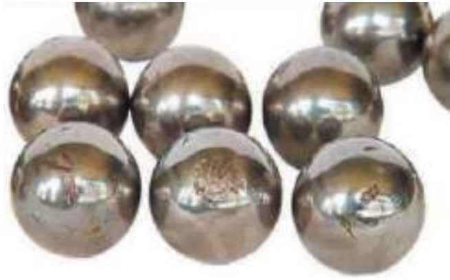
Рисунок 1.8 – Втомне викришування кульок підшипника
