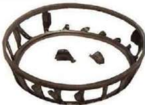
Рисунок 1.13 – Руйнування перемичок сепаратора конічного роликового підшипника
