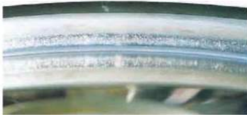
Рисунок 1.9 – Внутрішнє кільце конічного наполегливого роликпідшипника із задирами на поверхні буртика внутрішнього кільця
