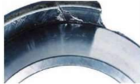
Внутрішнє кільце сферичного роликопідшипника з розломом на великому буртику
