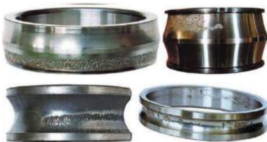
Рисунок 1.7 – Втомне викришування доріжок підшипника
