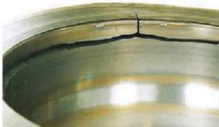
Рисунок 1.11 – Зовнішнє кільце дворядного циліндричного роликopідшипника з тріщинами, спрямованими назовні в осьовому та периферійному напрямках від осередку розвитку втомного викришування на поверхні доріжки кочення.
