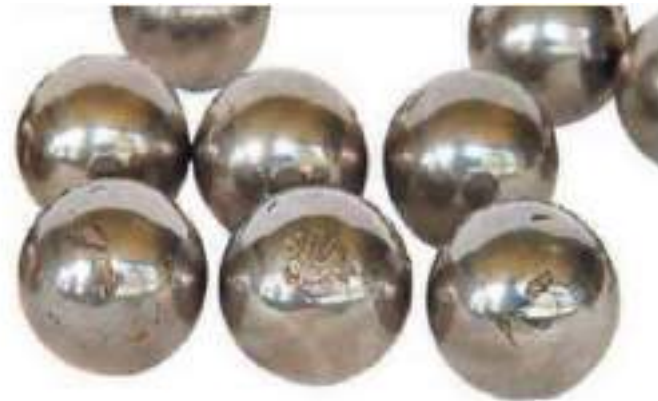
Втомне викришування кульок підшипника
