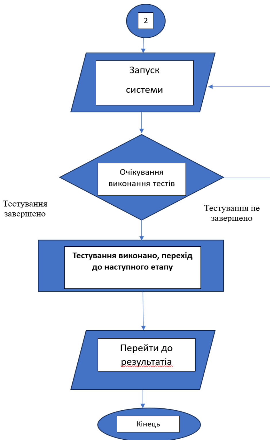
Рисунок 2.3 – Заключний етап процесу тестування
