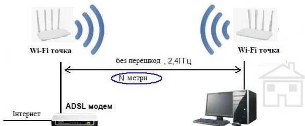
Рисунок 2.2 – Модель роботи Wi-Fi точок для 2,4 ГГц без перешкод
