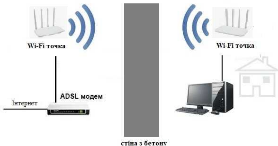
Рисунок 2.3 – Модель роботи Wi-Fi точок з перешкодою (бетонна стіна)
