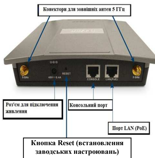
Рисунок 4.2 – Порти маршрутизатора DAP-2690
