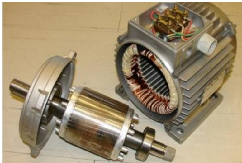
Рисунок 1.1 – Конструкція трифазного асинхронного двигуна [3]
