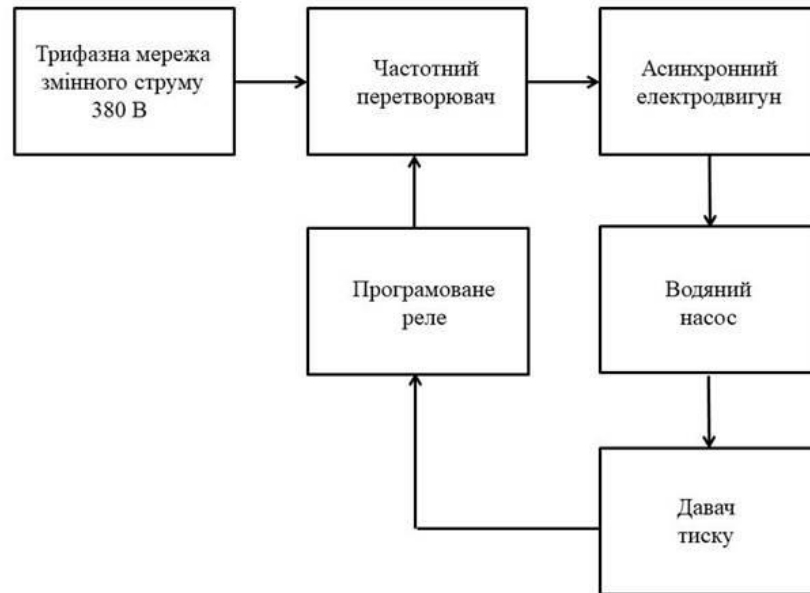
Рисунок 2 - Структурна схема системи автоматичного керування електричним двигуном для водопостачання
