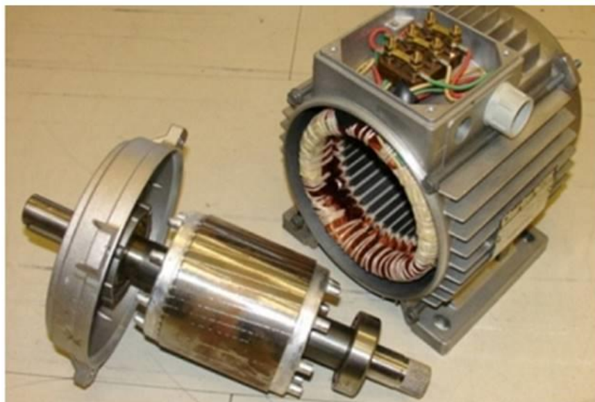
Рисунок 1 – Конструкція трифазного асинхронного двигуна
