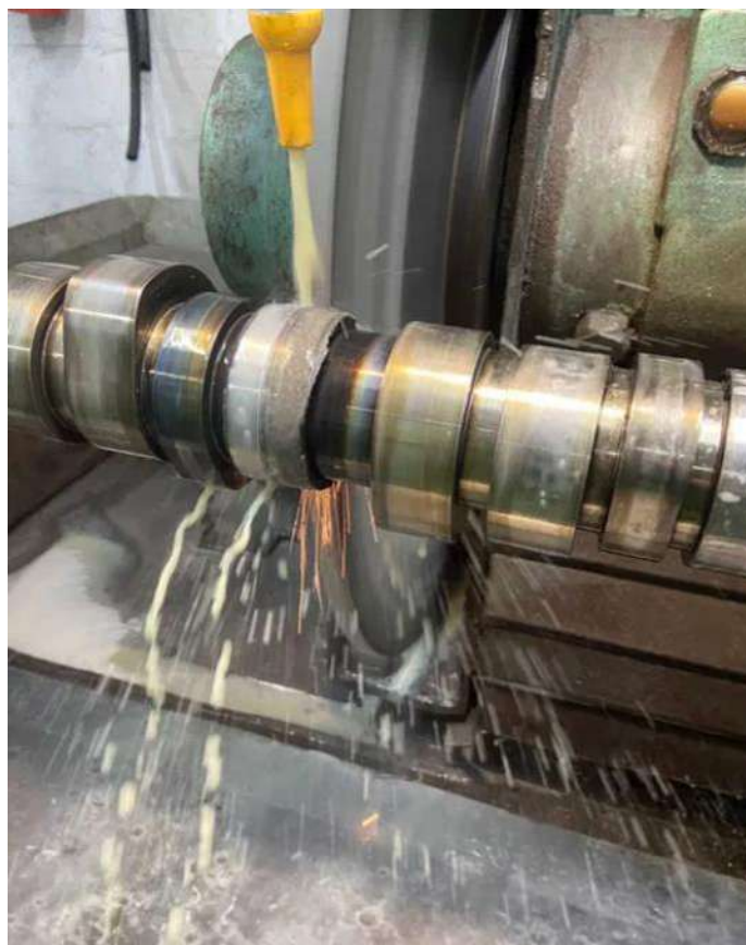
Рисунок 2.7 – Процес шліфування опорних шийок валу [15]
