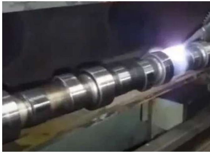
Рисунок 2.9 – Процес відновлення шийки розподільного валу електроімпульсним наплавленням [16]
