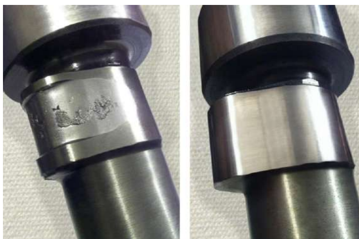
Рисунок 2.8 – Відновлені шийки розподільного валу [15] хромуванням та шліфуванням
