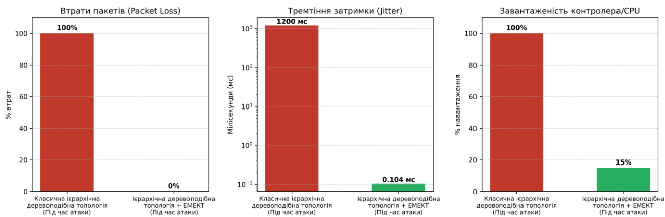
Рисунок 4.12 – Порівняльна діаграма показників живучості мережі та QoS під час імітації DoS-атаки
