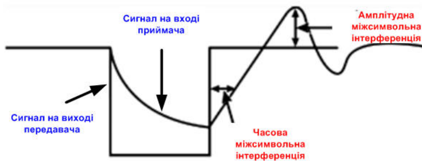
Рисунок 1.6 – Механізми появи міжсимвольної інтерференції цифрового сигналу
