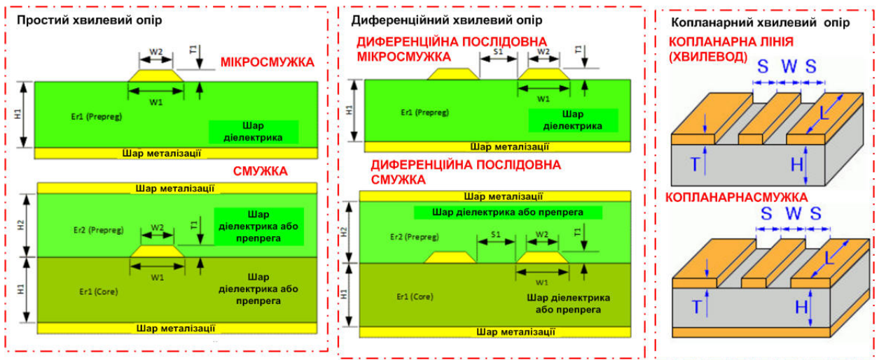
Рисунок 2.6 – Зони використання різних визначень хвильового опору для різних типів ліній передач на базі друкованих провідників
