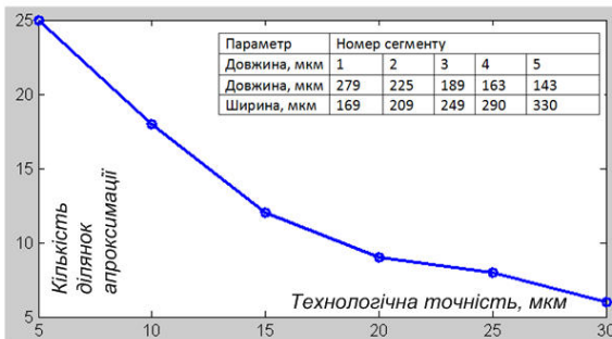
Рисунок 1 – Залежність кількості ділянок від технологічної точності та габарити прямокутних ділянок апроксимації плавного переходу для спряження ліній 150мкм та 300мкм
