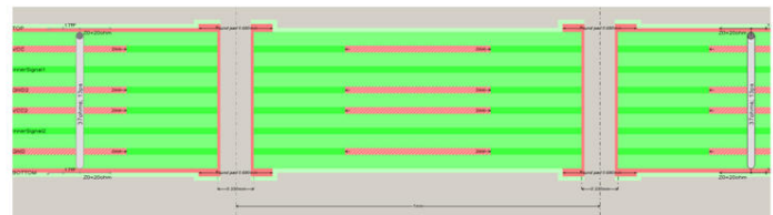
Рисунок 5 – Параметри зони диференційних перехідних наскрізних отворів без контакту із внутрішніми шарами
