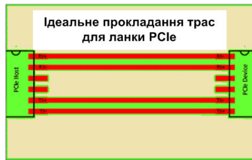
Рисунок 3.1 – Найкраща топологія прокладання друкованих провідників для послідовних високошвидкісних дуплексних інтерфейсів
