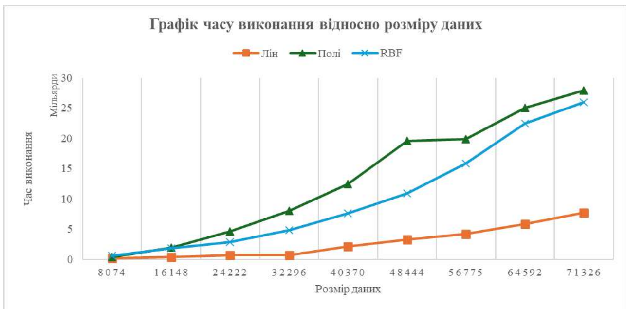
Рисунок 4.5 – Вбудоване програмне забезпечення для алгоритму SVM на основі СО: Графік часу виконання та розміру даних для набору даних-експериментів «Pulsar»
