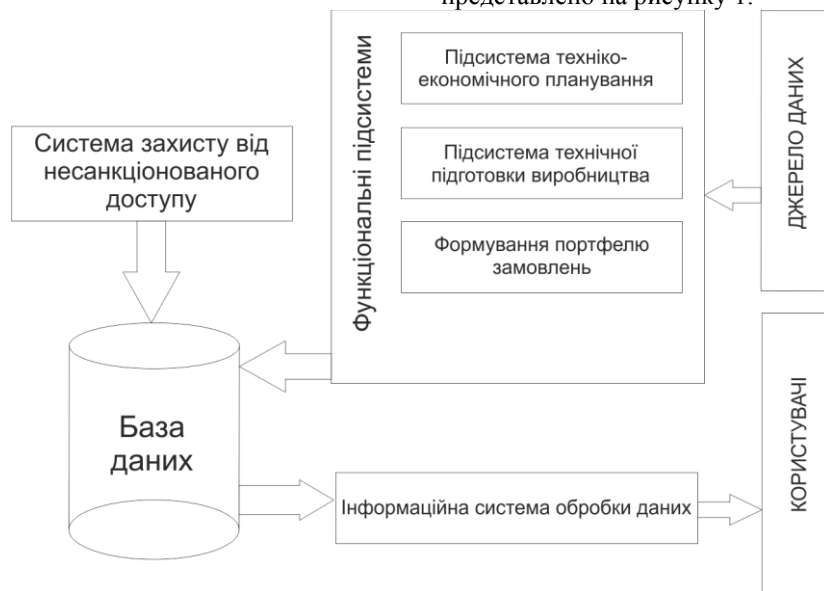
Рис. 1. Структура інформаційної системи, що включає в себе інформаційну підсистему обробки даних
