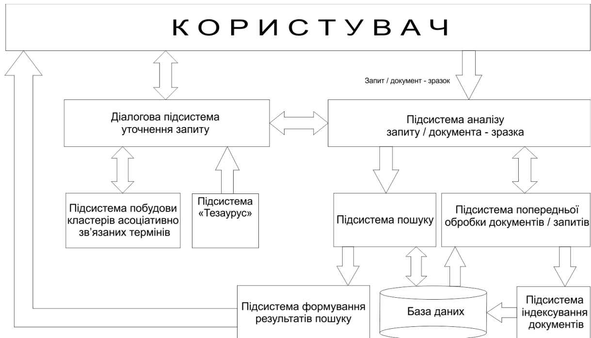
Рис. 2. Структурна схема інформаційної системи обробки даних
