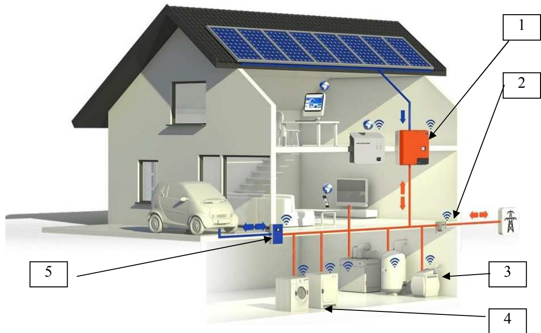
1 – блок перетворення сонячної енергії; 2 – блок передачі інформації в мережу; 3, 4 – побутові пристрої; 5 – зарядний пристрій для електроавтомобіля [6, 7] Рисунок 1.5 - Безпроводова система автоматизації
