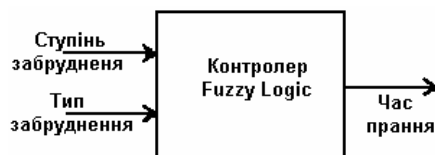
Рис. 6.66 – Схема мікроконтролера системи Fuzzy Logic, що керує роботою пральної машини
