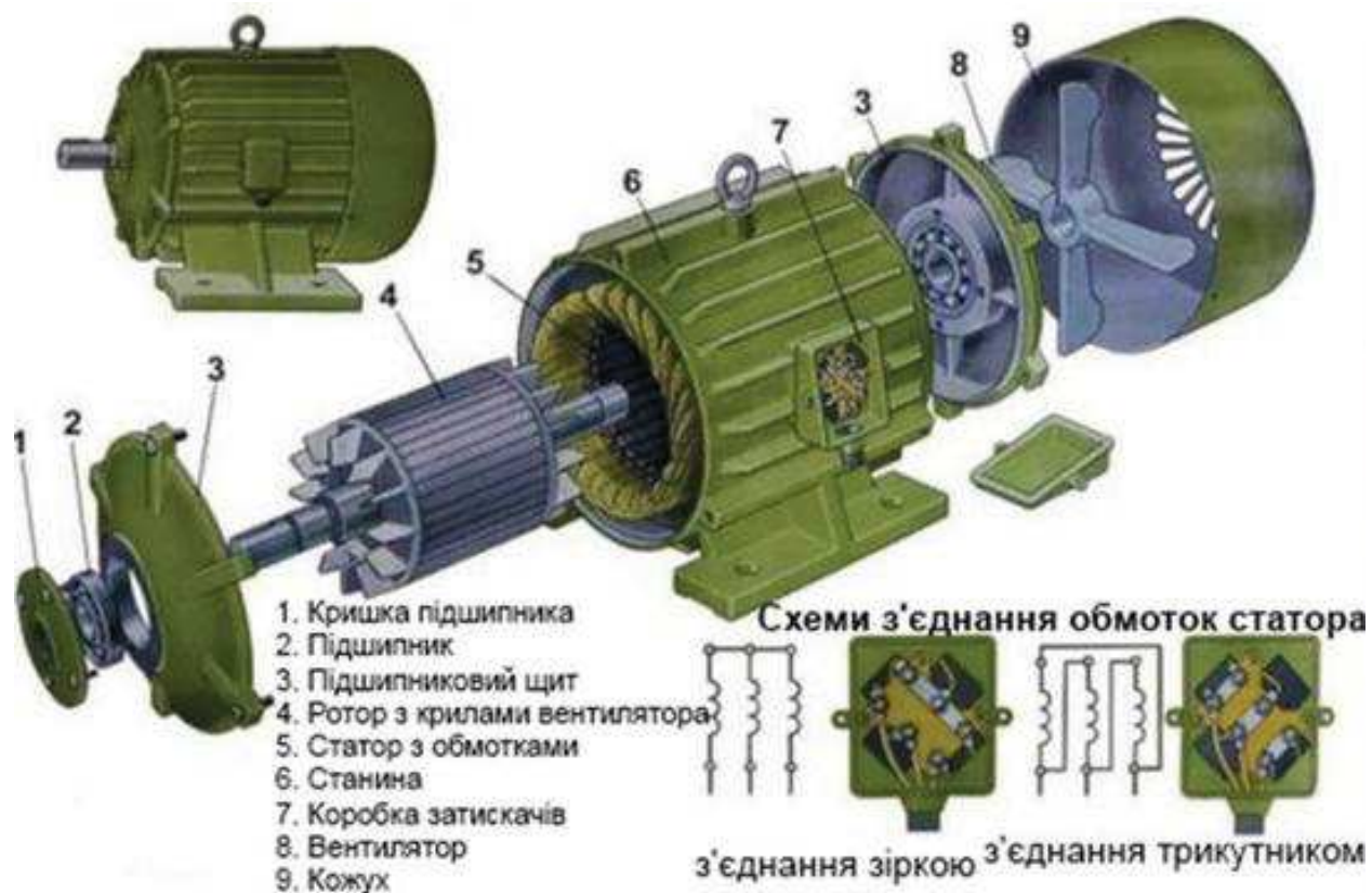
Рисунок 1.1 – Будова асинхронної машини змінного струму
