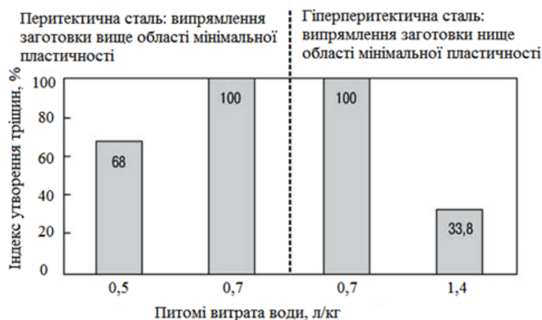
Рис. 1 – Порівняння індексу розтріскування перитектичної та суперперитектичної сталі при різних методах охолодження
